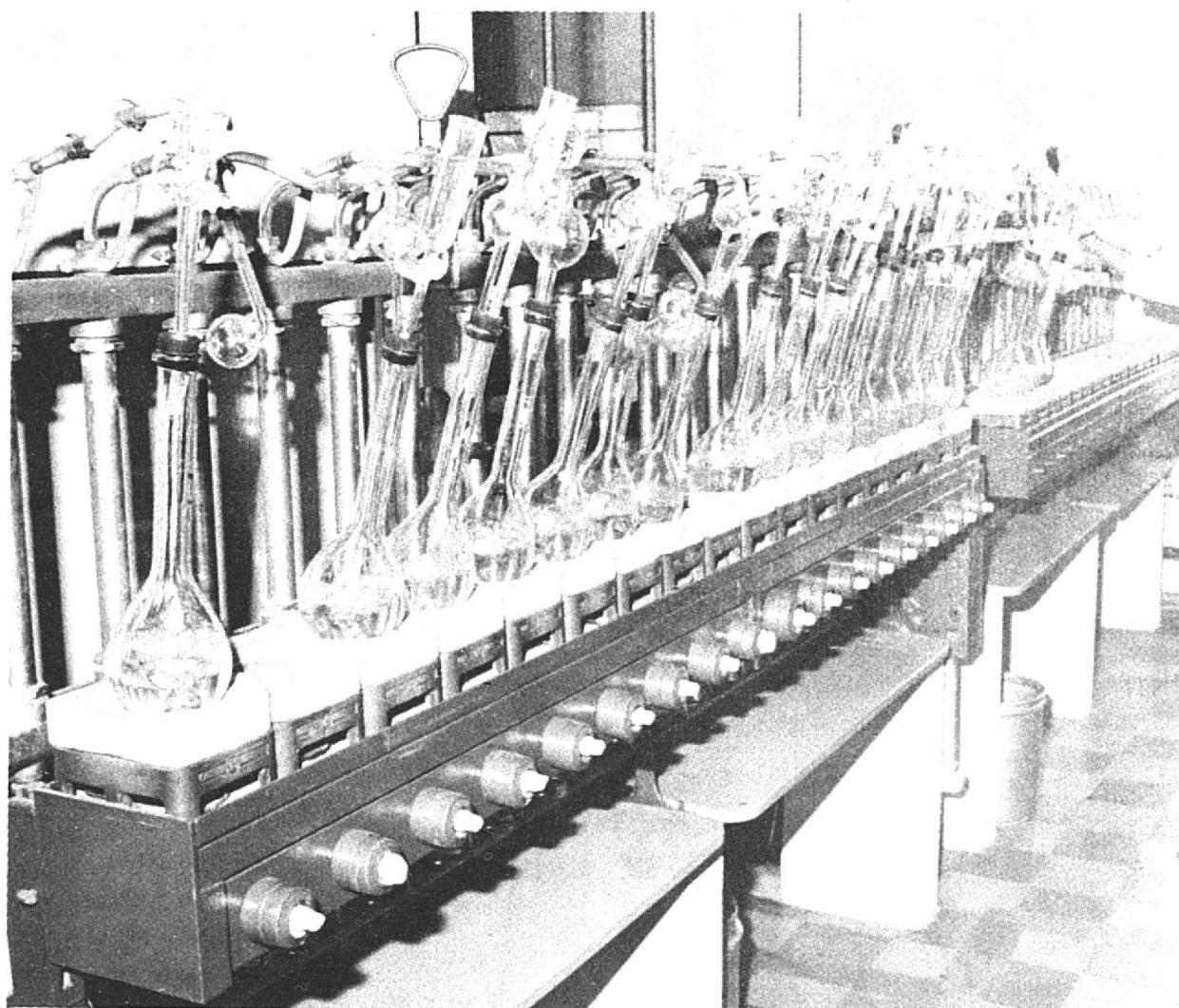
Laboratorio para determinación de nitrógeno
