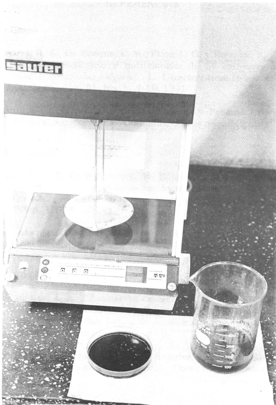
Equipo utilizado para determinación de espesor de caldo
