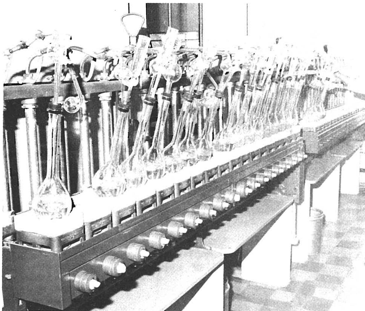
Laboratorio para determinación de nitrógeno
