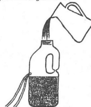
5 — Vierta agua en el recipiente inclinable hasta que llegue casi al nivel de los orificios de la parte de atrás de la botella. Use el palito para colgar el recipiente en el baño o afuera en un árbol. El recipiente estará listo para su uso.
